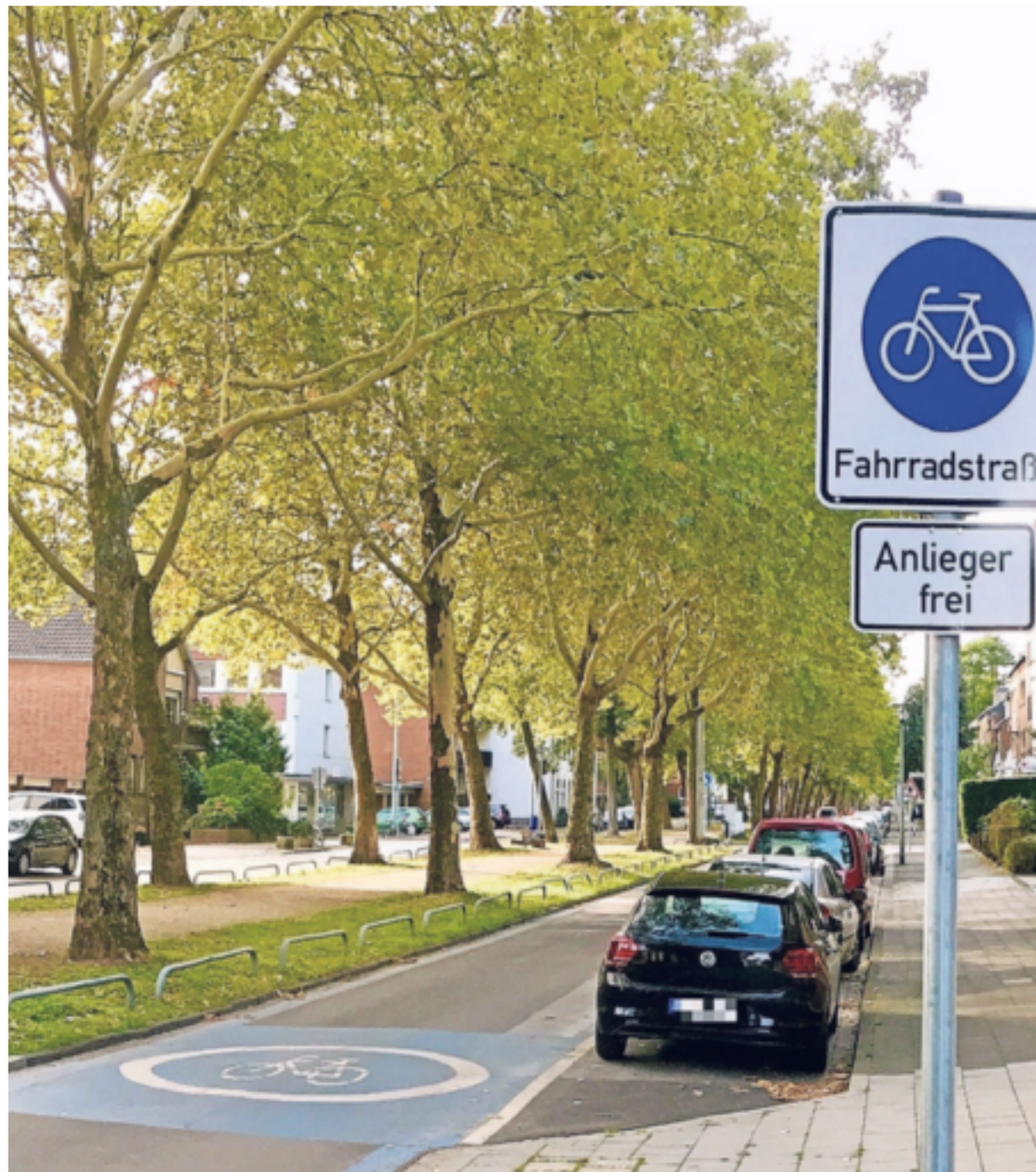
Die Beschilderung und das Piktogramm auf dem Asphalt zeigen, worum es geht: Hier haben Radfahrer Vorrang, nur Anlieger dürfen die Straße mit dem Auto nutzen – und das bei maximal 30 Kilometern pro Stunde.
