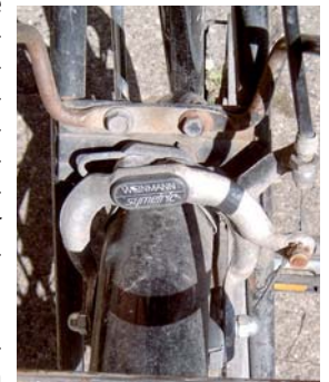
Abbildung 1: Beispiel Felgenbremse das Rad nicht zu alter Bauart (Quelle Wikipedia)
